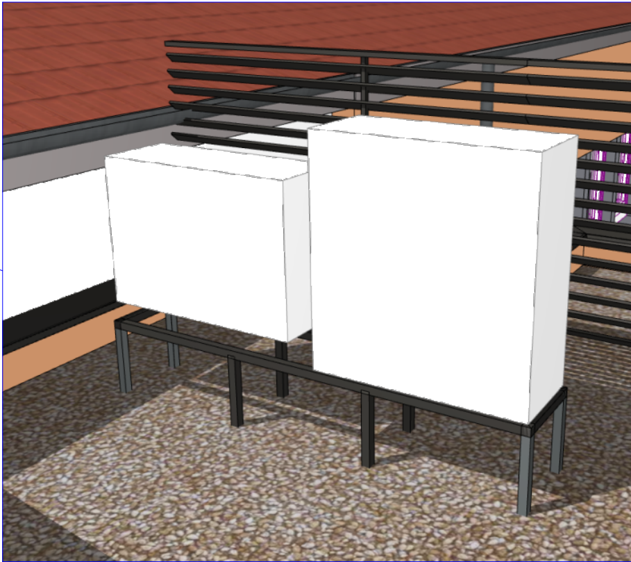
Principe support Onduleur et Groupe clim
